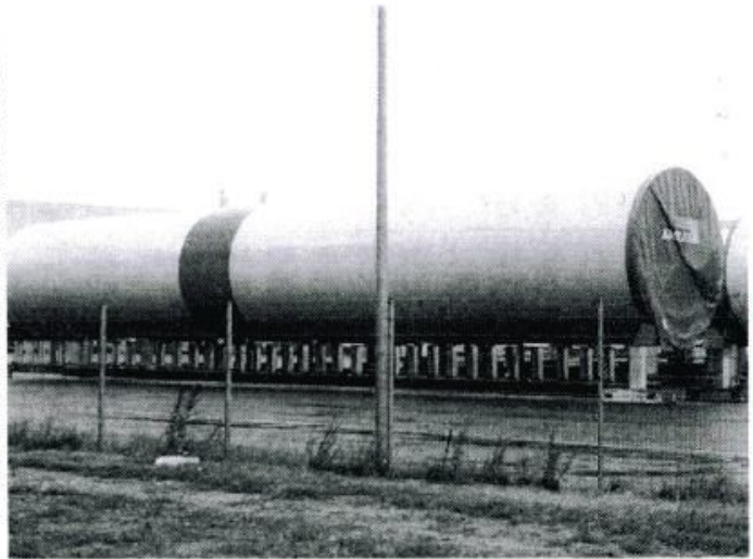
風力発電の支柱は、現場でつなぎ合わせて組み立てる。一部分でも近くで見ると、その巨大さが実感できる。(ドイツ)
